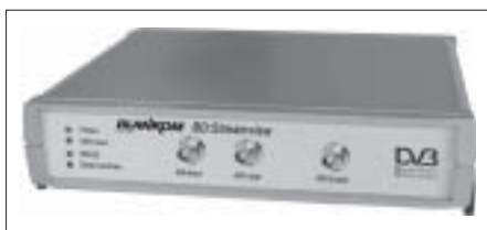
BD:Streamview – ein kostengünstiges Gerät zur schnellen Analyse von MPEG-2-Transportdatenströmen.
