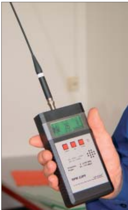
Mit Hilfe des SSP-Set lassen sich Leckstellen oder gebrochene Kabel genau lokalisieren.
